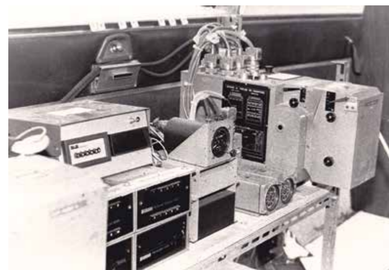
Parte della strumentazione installata sul King Air per registrare i dati di funzionamento del nuovo motore
