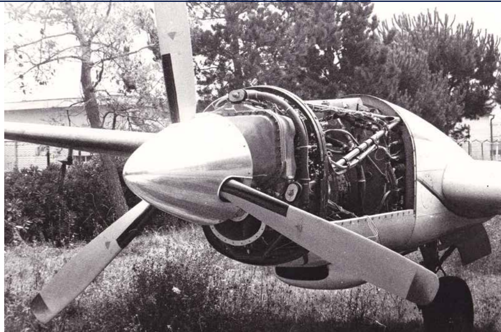
L'AR318 installato sulla semiala destra del King Air
